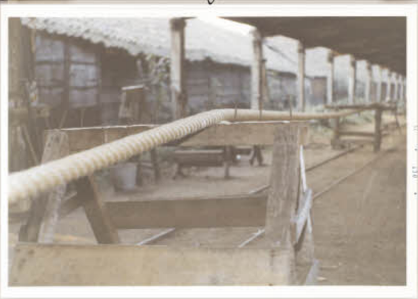
87. Afleggen 4-strengs kabel, boven 88. Afwerken en twisten van de uiteinden, midden 89. De kabel, zo lang als touwbaan, is klaar, onder
